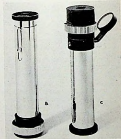
De zakspectroscopie in twee uitvoeringen. Rechts met periscopie.
