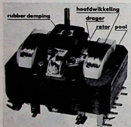
Afb. 3 - Symmetrische spleetpoelmotor (2 pol. uitvoering).
